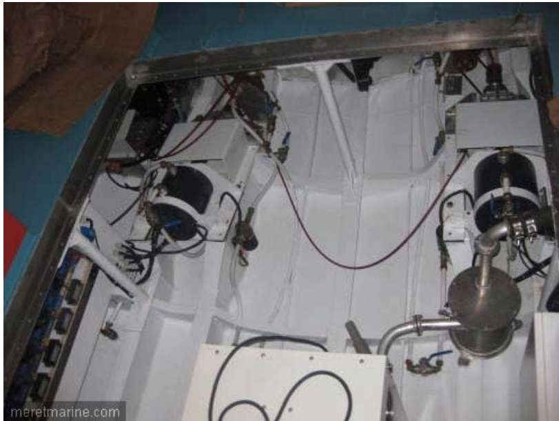
Compartment moteurs de l'Ecocono (© : ODC MARINE)
